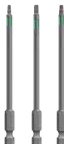
Las puntas Torsion de kwb son idóneas para las atornilladuras duras. Modelo extra largo de 100 mm para alcanzar los tornillos situados a profundidad o en lugares de difícil acceso. La zona de torsión de longitud máxima permite torcer el extremo de la punta durante los picos de carga y protege las puntas de romper prematuramente, prolongando así su vida útil. Fabricada de acero TQ60. Con tiras de color para reconocimiento, para diferenciar la forma de la cabeza. vástago E 6.3 de 1/4".
