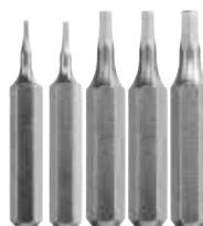
Embouts MICRO avec prise 6-pans, set de 5 pces. Embouts spécialement conçus pour une utilisation pour les plus petits raccords à vis. Utilisation entre autres dans les petites pièces électroniques et l'électronique de loisirs. Acier TQ60 de haute qualité. Embouts extra longs de 28 mm pour atteindre les vis difficilement accessibles. Avec queue 6-pans de 4 mm. Surface en finition satinée. Embouts sur bande de maintien pratique.
