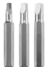
Embouts MICRO avec prise Robertson, set de 3 pces. Embouts spécialement conçus pour une utilisation pour les plus petits raccords à vis. Utilisation entre autres en électrotechnique et sur les voitures de collection. Acier TQ60 de haute qualité. Embouts extra longs de 28 mm pour atteindre les vis difficilement accessibles. Avec queue 6-pans de 4 mm. Surface en finition satinée. Embouts sur bande de maintien pratique.
