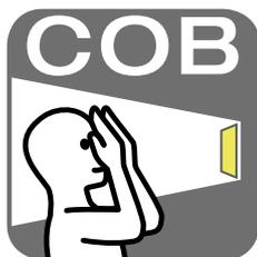
Nell'assortimento kwb arriva la più recente tecnologia del posizionamento di diodi luminosi. Nella tecnologia COB LED (tecnologia Chip on Board) i singoli diodi vengono raggruppati in un unico grande modulo di illuminazione. In questo modo raggiungiamo una superficie luminosa di fino a 10 volte superiore a fronte della stessa dimensione dei LED. Il risultato: un'efficienza luminosa omogenea senza precedenti a breve e media distanza.
