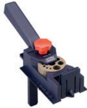
DÜBELPROFI Dübel-Bohr-Lehre, mit Parallelanschlag und Bohrlochabtaster, für Eck-, Winkel-, T- und Flächenverbindungen, Gummirutsicherung für glatte und empfindliche Oberflächen, für alle gängigen Dübel Ø 6, 8 und 10 mm, auch als Bohrlehre für präzise 90° Bohrungen von 3-12 mm geeignet.
