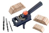
DÜBELPROFI Dübel-Bohr-Lehre, Komplettsatz, mit Holzdübeln, Ø 6, 8, 10 mm und CV Holzspiralbohrer Ø 6, 8, 10 mm, mit Parallelanschlag und Bohrlochabtaster, für Eck-, Winkel-, T- und Flächenverbindungen, Gummirutsicherung für glatte und empfindliche Oberflächen, für alle gängigen Dübel Ø 6, 8 und 10 mm, auch als Bohrlehre für präzise 90° Bohrungen von 3-12 mm geeignet.
