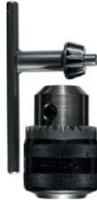
Zahnkranz-Bohrfutter, nach DIN 6349 L, schlagbohrfest, mit Schlüssel S2, Innengewinde (Form B), durchgebohrt für den Einsatz der Konter-Schraube als Linkslauf-Sicherung, für Standard- und rechts-/linkslaufende Bohrmaschinen.
