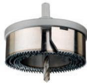
Lochsäge, 5-tlg., schwerer Zinkdruckguss-Trägerteller, Sägekränze aus gehärtetem Federstahl, Zahnschneiden induktiv gehärtet, für den Einsatz in Holz, kunststoffbeschichtete Hölzer, Hartholz, Spanplatten, Gipskarton, Leichtbauplatten, Kunststoff und Kupfer.
