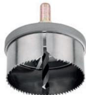
Lochsäge, 1-tlg., schwerer Zinkdruckguss-Trägerteller, Sägekränze aus gehärtetem Federstahl, für den Einsatz in Holz, Spanplatten, Gipskarton und Leichtbauplatten.
