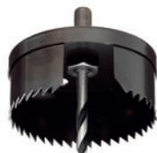
Lochsäge, 1-tlg., schwerer Zinkdruckguss-Trägerteller, Sägekränze aus gehärtetem Federstahl, für den Einsatz in Holz, Spanplatten, Gipskarton und Leichtbauplatten.
