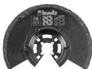
Fräst Fugen von Fliesen mit einer Schnittbreite von 2,2 mm bis zu einer Schnitttiefe von 85 mm, ideal für Arbeiten bis in Ecken, Eintauchen in das Material und Arbeiten auf ebener Oberfläche, z.B. beim Heraustrennen von schadhaften Fugen bei Fliesen oder Auswechseln einer beschädigten Fliese, Nuten fräsen in Kalksandstein oder Gasbeton für Kabelkanäle oder Rohre fräsen für Unterputzverlegung.
