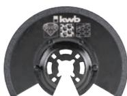
Fräst Fugen von Fliesen mit einer Schnittbreite von 1,3 mm bis zu einer Schnitttiefe von 12 mm, ideal für Arbeiten bis in Ecken, Eintauchen in das Metall und Arbeiten auf ebener Oberfläche, z.B. beim Heraustrennen von schadhaften Fugen bei Fliesen oder Auswechseln einer beschädigten Fliese, präzises Schneiden von kleinen Ausschnitten in weichen Fliesen für Rohranschlüsse oder Ecken, Nuten fräsen in Kalksandstein oder Gasbeton für Kabelkanäle oder Rohre fräsen für Unterputzverlegung.
