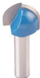
Hohlkehlfräser, hartmetallbestückt, 2-schneidig, Schneiden präzisionsgeschliffen, zur Herstellung von Kantenprofilen, dekorativen Ziernuten, strukturierung von Oberflächen und zum Einsatz in Kopierfräsmaschinen, für Hart- und Weichholz, für alle handelsüblichen handgeführten Oberfräser-Maschinen.
