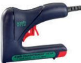
Elektrotacker TACKERTRONIX<sup>®</sup> TT 14, extra hohe Schlagkraft, Sicherheitshebel gegen unbeabsichtigtes auslösen, 220V/50/60 Hz Wechselstrom, doppel-schutzisoliert, funkentstört, Schlagfolge 20/min, für Klammern Typ 053 bis 14 mm, und Nägel Typ 055 bis 16 mm.
