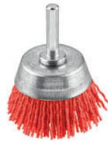
Topfbürste, Schleifnylon, Schleifkorn Aluminiumoxyd, zum Reinigen, Entfernen von Farbe und Lack und Anlassfarbe auf Schweißnähten, bei rostfreiem Stahl, für Holz, Metall, Buntmetall, Nichteisenmetall, auch geeignet zum Strukturieren von Holz, für Arbeiten auf mittelgroßen Flächen.
