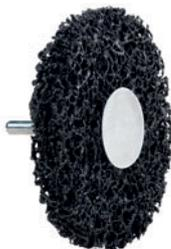
Reinigungscheibensortiment, 20-tlg., im Präsentationskarton, grob, zum Schleifen mit Stirn- oder Seitenfläche, flexibel, Nylonfilamente mit Siliziumcarbid Schleifkörpern verbunden, zum Reinigen und Endrosten von Stahlblech, NE-Metallen, Kunststoff, Stein und Holz, für den Einsatz in Bohrmaschinen.
