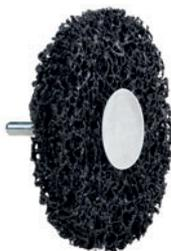
Reinigungscheibe, grob, zum Schleifen mit Stirn- oder Seitenfläche, flexibel, Nylonfilamente mit Siliziumcarbid Schleifkörpern verbunden, zum Reinigen und Endrosten von Stahlblech, NE-Metallen, Kunststoff, Stein und Holz, für den Einsatz in Bohrmaschinen, randgenaues Arbeiten möglich.
