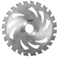
Mit Spannuten für höhere und schnellere Arbeitsleistung, hartmetallbestückt, präzise, saubere Schnitte. Spezial-Wechselzahn, speziell für Akku-Handkreissägen geeignet. Asymetrische Zahnteilung zur Lärmreduzierung von min. 30 %. Universell einsetzbar, für Spanplatten, beschichtete Spanplatten, Bauholz, Buntmetall, Bleche und Alu-Profile sowie Kunststoff inkl. Plexiglas, Holz mit Metallresten.
