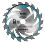
Mit Spannuten für höhere und schnellere Arbeitsleistung, hartmetallbestückt, präzise, saubere Schnitte. Spezial-Wechselzahn, speziell für Akku-Handkreissägen geeignet. Asymetrische Zahnteilung zur Lärmreduzierung von min. 30 %. Universell einsetzbar, für Spanplatten, beschichtete Spanplatten, Bauholz, Buntmetall, Bleche und Alu-Profile sowie Kunststoff inkl. Plexiglas, Holz mit Metallresten.
