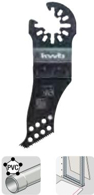
Con agujeros patentados para un mayor y mejor rendimiento, y con inserción de cambio rápido patentado. Inmersión sencilla en el material en cualquier punto, cortes rectos, para cortar en madera, placas de yeso encartonado, parquet, plástico, etc. P.ej., ideal para cortes largos, rectos en paredes de construcción en seco y revestimientos de paredes de madera, para el tendido de canalizaciones de cables, tuberías, etc.
