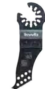
Avec perçages de serrage brevetés pour une puissance de travail plus élevée et plus rapide et logement de changement rapide. Pénétration facile dans le matériau à n'importe quel endroit pour couper droit dans le bois, les plaques de placoplâtre, le parquet, le plastique etc. L'idéal pour les coupes droites longues dans les murs de construction sèche et les revêtements de mur en bois, pour la pose de chambre de tirage, de conduites de tuyaux etc.
