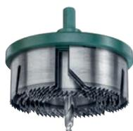
Con scanalature per trucioli brevettate per una prestazione di lavoro più elevata e veloce. Sega a tazza, 7 pz., piatto di supporto in pressoegetto di zinco pesante, corone di acciaio per molle indurite, punte dei denti a indurimento induttivo, per l'impiego nel legno, in legni rivestiti di plastica, legno duro, pannelli di truciolato, cartongesso, pannelli di costruzione leggera, plastica e rame.
