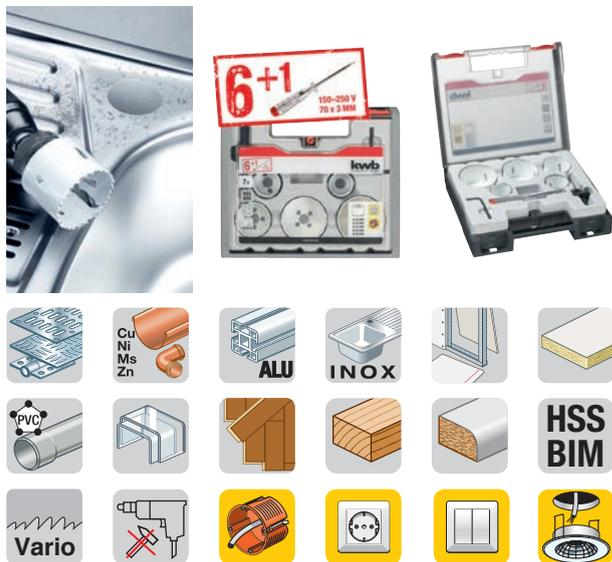
Sega a tazza in bimetallo HSS, dentatura progressiva Vario, per l'espulsione accelerata dei trucioli, dentatura HSS CO, legata con 8% COBALTO, estremamente resistente, lunga durata, per acciaio, ghisa grigia, acciaio da costruzione, lamiere di acciaio inossidabili, alluminio, bronzo, rame, materia plastica, acrilici, cartongesso e legno.
