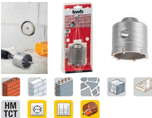
Tazza a corona, rivestita di metallo duro, a prova di percussione, a indurimento speciale, piastre di metallo duro a saldatura speciale resistente al calore, per l'impiego in muratura, pietra naturale, pietra artificiale, calcestruzzo, marmo e mattoni, per posare prese elettriche sottintonaco e passaggi per tubi.
