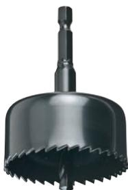
Sega a tazza, con gambo di alloggiamento a batteria 1/4" E 6.3, speciale per tutti gli avvitatori a batteria, BOSCH UNEO e miniavvitatori a batteria come BOSCH IXO. Ideale per praticare fori di lampade alogene a incasso.
