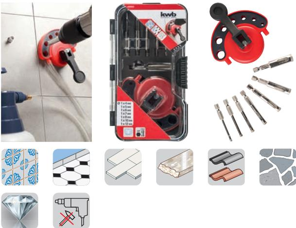
Set seghe a tazza DIAMANTE, da 8 pz., 7 seghe a tazza rivestite di polvere di DIAMANTE, pregiati diamanti industriali, per l'impiego anche nelle piastrelle più dure, corpi di base torniti dal pieno, con elevata precisione di rotazione, per fori per tassello, mascherina per foratura con ventosa e attacchi per condotte idriche, per grès porcellanato, lastre di granito, piastrelle, mattonelle, ceramica, lastre di pietra naturale, lastre di marmo.
