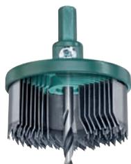
Con scanalature per trucioli brevettate per una prestazione di lavoro più elevata e veloce. Sega a tazza, 8 pz., piatto di supporto in pressoegetto di zinco pesante, corone di acciaio per molle indurite, punte dei denti a indurimento induttivo, per l'impiego nel legno, in legni rivestiti di plastica, legno duro, pannelli di truciolato, cartongesso, pannelli di costruzione leggera, plastica e rame.
