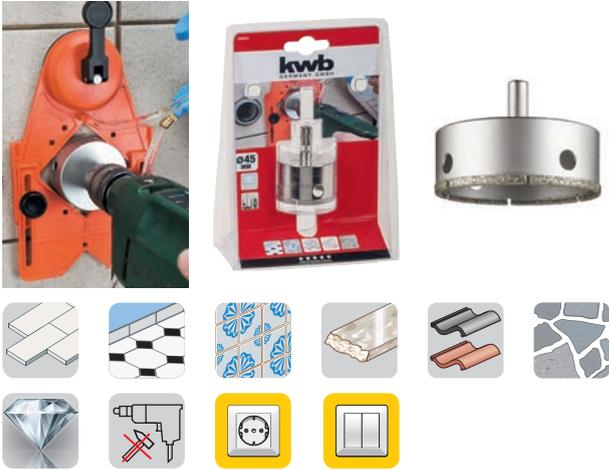
Seghe a tazza rivestite di polvere di DIAMANTE, pregiati diamanti industriali, per l'impiego anche nelle piastrelle più dure, corpi di base torniti dal pieno, con elevata precisione di rotazione, Ø da 5 a 35 mm per fori per tassello, attacchi dell'acqua, condotte idriche e Ø da 45 76 mm per tubi di scolo, prese elettriche e scatole di derivazione, per grès porcellanato, piastrelle, mattonelle, ceramica, lastre di pietra naturale, lastre di marmo.
