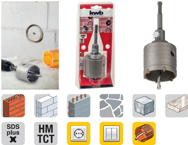
Corona a punta cava, rivestita di metallo duro, con gambo di alloggiamento SDS Plus e punta di centraggio Ø 8 mm, a prova di percussione, a indurimento speciale, piastre di metallo duro a saldatura speciale resistente al calore, per l'impiego in muratura, pietra naturale, pietra artificiale, calcestruzzo, marmo e mattoni, per posare prese elettriche sottintonaco e passaggi per tubi.
