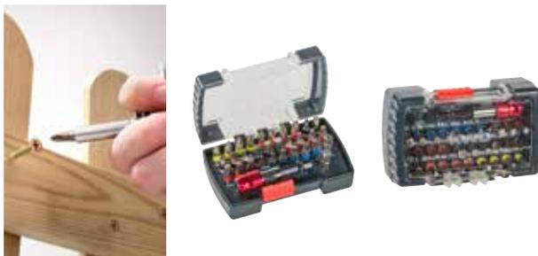
Bit-Box, 32-tlg., Industriequalität, TQ60-Stahl, Bits: Antrieb 1/4" Sechskant nach ISO 1173, C 6.3, mit Farbkennringen, zur Unterscheidung der Kopfform, Schnellwechsel-Bithalter, Antrieb 1/4" Sechskant nach ISO 1173, E 6.3, Box aus stabilem Kunststoff.
