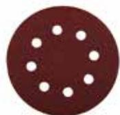
Schleifscheiben, Ø 125 mm, Holz & Metall, Edelkorund, Aluminiumoxyd bestreut, vollkunstharzgebunden, verstärktes Trägermaterial, mit Velours-Rückseite, gelocht, für Exzenterschleifer, zum Schleifen von Metall und Holz, Farbe, Lack, Spachtel, Stein und Kunststoff.
