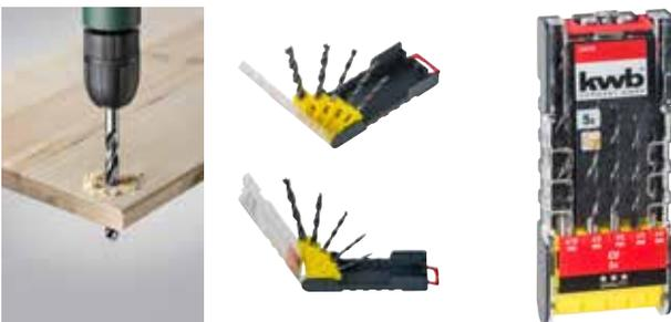
Holzspiralbohrersatz, CV-Stahl, spanlos geformt, 2-Fasen Spiralförmig, für stabilen Geradeauslauf, Farbe schwarz, blankgeschliffene Spiralen, mit Zentrierspitze und Schulterschneide, für präzise ausrissfreie Bohrungen, Schaft zylindrisch, Industriequalität, für Weich- und Hartholz.
