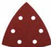
Schleifdreiecke, 93 mm, Holz & Metall, Edelkorund, Aluminiumoxyd bestreut, vollkunstharzgebunden, verstärktes Trägermaterial, mit Velours-Rückseite, gelocht, für Delta-/Dreieckschleifer, zum Schleifen von Metall und Holz, Farbe, Lack, Spachtel, Stein und Kunststoff.
