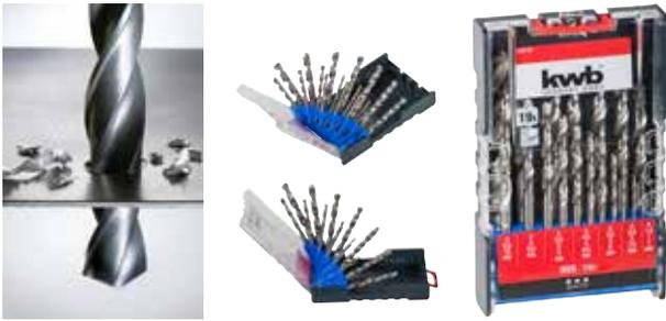
HSS Spiralbohrersatz, nach DIN 338, rechtsschneidend, Typ N, rollgewalzte Spirale mit geschliffener Fase, dampfangelassen, poliertes Finish, Spitzwinkel 118°, zylindrisch, für z.B. legierten und unlegierten Stahl, Grauguss, NE-Metalle, Hartkunststoffe.
