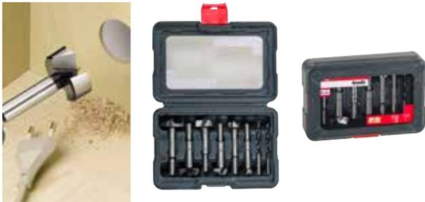
Forstnerbohrersatz, nach DIN 7483 G, Holzbearbeitung, Bohrkopf geschmiedet und geschliffen, 2 Hauptschneiden und 2 Seitenschneiden, Zentrierspitze, Farbe blank mit schwarzen Nuten, Holzspiralbohrer, CV Stahl, spanlos geformt, Farbe schwarz, blank geschliffene Spirale, mit Zentrierspitze und 2 Vorschneidern, für alle Dreh- und Schlagbohrmaschinen mit 10 / 13 mm Futter, für Hart- und Weichholz, funiertes Holz, Tischlerplatten. Ausrissfreie Bohrlöcher auch bei großen Durchmessern.
