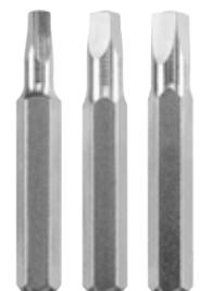
Micro bit con attacco Robertson, set da 3 pezzi. Bit appositamente concepiti per l'impiego in avvitamenti piccoli. Impiego nell'elettrotecnica e negli oldtimer. Pregiato acciaio TQ60. Bit ultralunghi da 28 mm per raggiungere viti difficilmente accessibili. Con gambo esagonale da 4 mm. Superficie con finitura satinata. Bit sulla pratica fascia di supporto.
