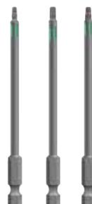
I bit Torsion della kwb sono particolarmente adatti per i casi di avvitamento duri. Esecuzione ultralunga da 100 mm per raggiungere viti profonde o difficilmente accessibili. La zona di torsione dalla lunghezza massima consente la torsione della punta del bit e protegge i bit da una rottura precoce aumentando la durata di impiego. Prodotti in acciaio TQ60. Con strisce di identificazione a colori per distinguere la forma della testa. Gambo 1/4" E 6.3.
