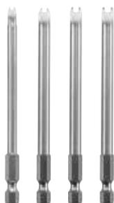
Safety bit con attacco Spanner, set da 4 pezzi. Bit appositamente concepiti per l'impiego negli avvitiamenti di sicurezza. Impiego tra l'altro negli elettrodomestici e nell'elettronica di intrattenimento. Pregiato acciaio TQ60. Bit ultralunghi da 100 mm per raggiungere viti profonde a difficilmente accessibili. Con gambo 1/4" E6.3. Superficie con finitura satinata.
