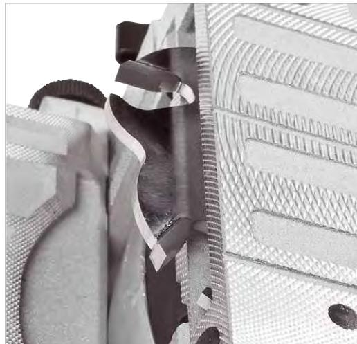
Eine Flachdübelfräse besitzt ein Sägeblatt wie eine Kreissäge, mit dem die Nut gefräst wird
