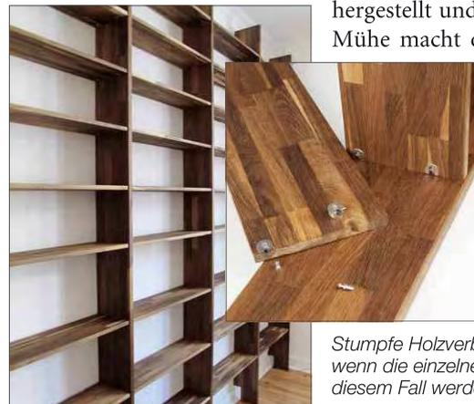
Stumpfe Holzverbindungen kommen oft im Regalbau vor, wenn die einzelnen Regalbretter eingebaut werden, in diesem Fall werden sie durch Beschläge gehalten
