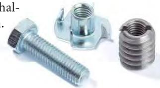
Um die Zugfestigkeit von Einschlag- und Eindrehhülsen zu erhöhen, werden diese von hinten eingesetzt, sodass sie sich bei Zug im Holz „abstützen“ können
