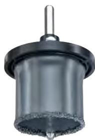
Sierra de corona, revestida de carburo de tungsteno, con plato de apoyo y broca de centraje, tubo de precisión, recubierta de partículas especiales de carburo de tungsteno, soldada a alta temperatura, para hormigón celular, mampostería, baldosas, cerámica, piedra natural, paneles de construcción ligera, cartón de yeso y plástico, para trabajos de instalación como por ejemplo montaje de cajas de enchufe y cajas de distribución y para el tendido de tubos.
