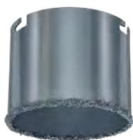
Sierra de corona, revestida de carburo de tungsteno, recubierta de partículas especiales de carburo de tungsteno, soldado a alta temperatura, para hormigón celular, mampostería, baldosas, cerámica, piedra natural, paneles de construcción ligera, cartón de yeso y plástico, para trabajos de instalación como por ejemplo montaje de cajas de enchufe y cajas de distribución y para el tendido de tubos.
