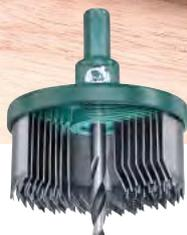
Con ranuras patentadas para un mayor y mejor rendimiento. Sierra de corona, 8 piezas, plato de apoyo de zinc colado a presión, coronas de acero templado para muelles, puntas de los dientes templadas por inducción, para el uso en madera, maderas revestidas de plástico, madera dura, planchas de conglomerado, planchas de yeso encartonado, placas de construcción ligera, plástico y cobre.
