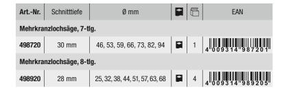
gerteller, Sägekränze aus gehärtetem Federstahl, Zahnspitzen induktiv gehärtet, für den Einsatz in Holz, kunststoffbeschichtete Hölzer, Hartholz, Spanplatten, Gipskarton, Leichtbauplatten, Kunststoff und Kupfer.
