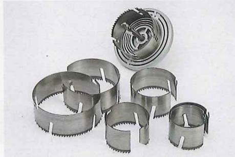
Durchbrüche im Sägekörper verbessern die Spanabfuhr und kühlen – ein „Brennen“ der Säge wird dadurch verhindert.
