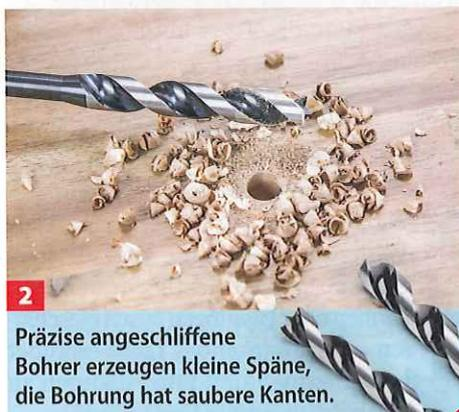
**2** Präzise angeschliffene Bohrer erzeugen kleine Späne, die Bohrung hat saubere Kanten.
