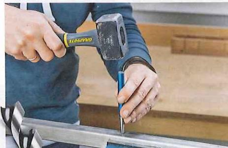
Damit die Bohrspitze auf glatten Oberflächen nicht verläuft, Bohrstelle ankörnen.
