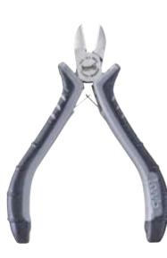
Elektronik-Seitenschneider nach DIN ISO 9654, CV Stahl, Satin-Finish matt, schlanke Form, 2-Komponentengriff für optimale Kraftübertragung und ermüdungsfreies Arbeiten, für Kupferdraht max. Ø 1,5 mm, selbstöffnend, für Arbeiten an elektronischen Bauteilen und in der Feinmechanik, für feinste Schneidarbeiten. Mit praktischem Zangenhalter für die Werkstatt, dafür wird der Kunststoffclip einfach an die Werkzeugwand geschraubt.
