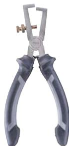
Abisolierzangen-Form nach DIN ISO 5743, CV-Stahl, Satin-Finish matt, 2-Komponentengriff für optimale Kraftübertragung und ermüdungsfreies Arbeiten, mit Feder und Stell-schraube, stufenlos einstellbar, für ein-, mehr- und feindrätige Leiter mit Kunststoff- oder Gummiisolation. Mit praktischem Zangenhalter für die Werkstatt, dafür wird der Kunststoffclip einfach an die Werkzeugwand geschraubt.
