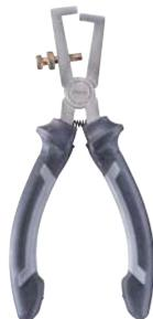
Forma della pinza spelafili secondo DIN ISO 5743, acciaio CV, finitura in satin opaco, impugnatura bicomponente per una trasmissione di forza ottimale e un lavoro senza fatica, con molla e vite di regolazione, a regolazione continua, per conduttori a uno o più fili o a fili sottili con isolamento di plastica o di gomma. Con pratico portapinzine per l'officina dotato di clip di plastica per l'avvitamento facile al pannello portautensili.
