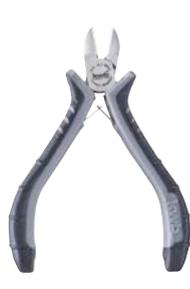
Tronchese a taglio laterale per l'elettronica secondo DIN ISO 9654, acciaio CV, finitura in satin opaco, forma sottile, impugnatura bicomponente per una trasmissione di forza ottimale e un lavoro senza fatica, autoaprente, per filo di rame max. Ø 1,5 mm, per lavori su componenti elettronici e nella meccanica di precisione, per lavori di taglio raffinati. Con pratico portapinzine per l'officina dotato di clip di plastica per l'avvitamento facile al pannello portautensili.
