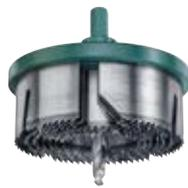
Mit patentierten Spannuten für höhere und schnellere Arbeitsleistung. Lochsäge, 7-tlg., mit Sechskant-Aufnahmeschaft, schwerem Aluguss-Trägerteller, Sägekränze aus gehärtetem Federstahl, Zahnschneiden induktiv gehärtet, für den Einsatz in Holz, kunststoffbeschichtete Hölzer, Hartholz, Spanplatten, Gipskarton, Leichtbauplatten, Kunststoff und Kupfer.
