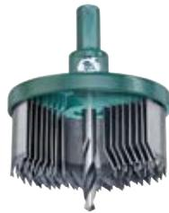
Mit patentierten Spannuten für höhere und schnellere Arbeitsleistung. Lochsäge, 8-tlg., mit Sechskant-Aufnahmeschaft, schwerem Aluguss-Trägerteller, Sägekränze aus gehärtetem Federstahl, Zahnschneiden induktiv gehärtet, für den Einsatz in Holz, kunststoffbeschichtete Hölzer, Hartholz, Spanplatten, Gipskarton, Leichtbauplatten, Kunststoff und Kupfer.
