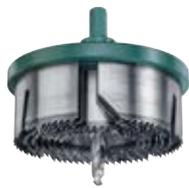
Avec rainures de serrage brevetées pour une puissance de travail plus élevée et plus rapide. Scie à guichet, 7 pièces, plaque de support en zinc coulé sous pression particulièrement lourdes, couronnes en acier à ressort trempé, pointes des dents trempées par induction, pour l'utilisation sur le bois, les bois à revêtements, les bois durs, les panneaux d'agglomérés, le carton-plâtre, les panneaux de construction légers, le plastique et le cuivre.
