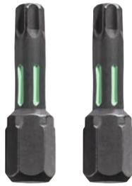
Die kwb Torsions Bits sind besonders für den harten Schraubfall geeignet. Die spezielle Torsionszone ermöglicht das Verwinden der Bitspitze bei Belastungsspitzen und schützt die Bits vor vorzeitigem Brechen und erhöht somit die Einsatzdauer. Hergestellt aus TQ 60 Stahl. Mit Farbkennstreifen, zur Unterscheidung der Kopfform. 1/4" C 6.3 Schaft.
