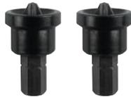
Bits mit Tiefenstopp, Antrieb 1/4" Sechskant nach ISO 1173, C 6.3, für bündige Verschraubung von Leichtbauplatten wie z.B. Gipskarton, verhindert das unbeabsichtigte Durchschrauben.
