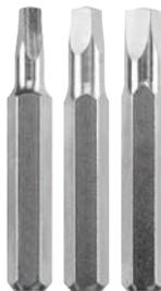
Embouts MICRO avec prise Robertson, set de 3 pces. Embouts spécialement conçus pour une utilisation pour les plus petits raccords à vis. Utilisation entre autres en électrotechnique et sur les voitures de collection. Acier TQ 60 de haute qualité. Embouts extra longs de 28 mm pour atteindre les vis difficilement accessibles. Avec queue 6-pans de 4 mm. Surface en finition satinée. Embouts sur bande de maintien pratique.
