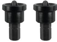
Bits avec butée de profondeur, entraînement 1/4" 6-pans selon ISO 1173, C 6.3, pour le vissage à fleur de panneaux d'aggloméré comme le pla-plâtre, évite de transpercer involontairement.
