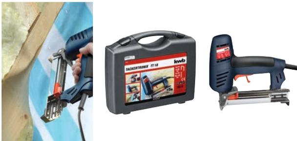
Elektrotacker TACKERTRONIX TT 18, Profigerät im Kunststoffkoffer, extra hohe Schlagkraft, Sicherheitshebel gegen unbeabsichtigtes Auslösen, 220V/50/60 Hz Wechselstrom, doppelschutzisoliert, funkentstört, Schlagfolge 20/min, für Klammern Typ 053 bis 20 mm und Nägel Typ 055 bis 19 mm.
