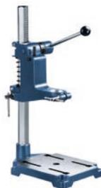
Geeignet für alle handelsüblichen Bohrmaschinen mit Eurohals Ø 43 mm, für exakte Bohrungen und Fräsungen in Holz/Metall-Profilen, incl. Rückholfeder, Tiefenanschlag und mm-Skala. Grauguss-Grundplatte 175 x 210 mm mit Befestigungsschlitzen für Maschinenschraubstock (Art.-Nr. 777068, 80 mm, nicht im Lieferumfang enthalten). Gesamthöhe 500 mm, Sechskant-Säule stufenlos drehbar um 360°, Säulen Ø 34 mm, Ausladung 130 mm.
