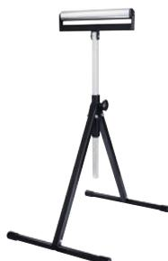
Rollenauflegebock, klappbar, stufenlos verstellbare Arbeitshöhe, 650-1100 mm, einsetzbar an allen handelsüblichen Maschinen und Werkbänken, zum Auflegen und Abrollen von langen Brettern, Dielen, Platten, Stäben und Rundmetallen, die gelagerte Auflagenrolle ermöglicht ein leichtes Zuführen der Materialien in die Bearbeitungsrichtung.
