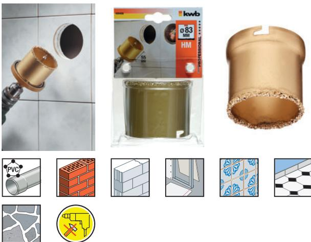
Lochsäge, hartmetallbestreut, Träger Präzisionsrohr, bestreut mit speziell Hartmetall-Split, hochtemperaturgelötet, für Gasbeton, Mauerwerk, Fliesen, Keramik, Naturstein, Leichtbauplatten, Gipskarton und Kunststoff, für Installationsarbeiten, wie z.B. Steckdosen-, Verteilerdoseneinbau und Rohrverlegung.
