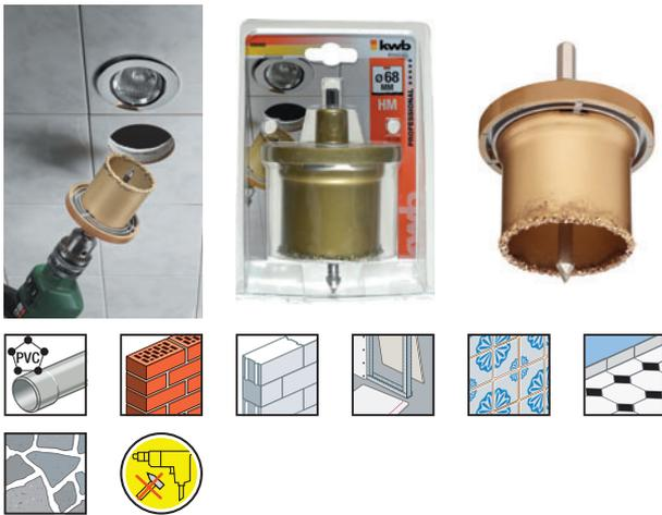
Lochsäge, hartmetallbestreut, komplett mit Trägerteller und Zentrierbohrer, Präzisionsrohr, bestreut mit speziell Hartmetall-Split, hochtemperaturgelötet, für Gasbeton, Mauerwerk, Fliesen, Keramik, Naturstein, Leichtbauplatten, Gipskarton und Kunststoff, für Installationsarbeiten, wie z.B. Steckdosen-, Verteilerdoseneinbau und Rohrverlegung.
