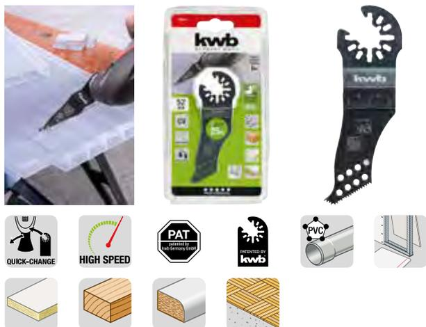
Con fori di scarico per trucioli brevettati per una prestazione di lavoro più elevata e veloce e alloggiamento a sostituzione rapida brevettato. Facile immersione nel materiale in ogni punto, tagli dritti, per tagliare legno, pannelli di cartongesso, parquet, plastica ecc. Ideale p. es. per tagli lunghi, dritti nelle pareti prefabbricate a secco e nei rivestimenti di pareti di legno, per la posa di pozzetti di distribuzione per cavi, tubature etc.
