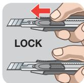
Der manuelle Klingenschieber mit Autolock-Funktion riegelt automatisch in seiner Position ab.
