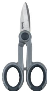
handliche, kleine, 140 mm lange Kabel- oder Elektriker-Schere zum Schneiden oder Abmanteln von Kabeln, Edelstahl-Scherenklinge, Abisolier-Aussparung, eine Schneide mit feiner Sägezahnung um ein Abrutschen des Kabels zu verhindern, verschraubtes, nachjustierbares Gelenk, 2-Komponenten-Griff in ergonomischer Spezial-Form, schneidet Kabel, dünnen Draht, Isolierband, Papier, Pappe, für Rechts- und Linkshänder geeignet.
