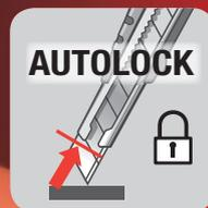
Je nach Nutzung des Klingenschiebers ist das Messer in seine Position zu schieben und über dem Klingenschieber und der seitlichen Zuführung in der Klingenföhrung ist das Klingemesser automatisch verriegelt.
