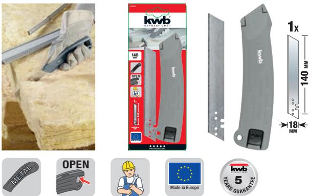
Handwerkerqualität, mit 1 Stück 140 x 18 mm Dämmstoffklingen, Komfortriegelung am Griff für werkzeugloses Wechseln der verbrauchten Klinge, ergonomisch geformtes Zink-Druckgussgehäuse, geeignet zum Schneiden von Glasfaser und anderen Dämm- und Schaumstoffen sowie Styropor, 173 Länge.
